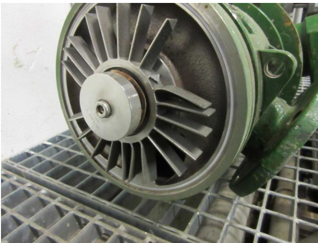
Poškozené kolo In-line čerpadla P102.3:
